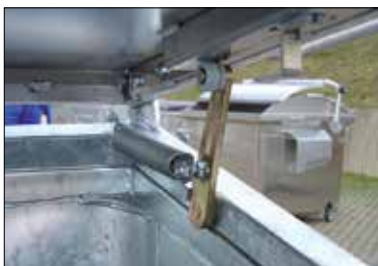
A tampa mantém-se aberta através de um sistema de molas.
