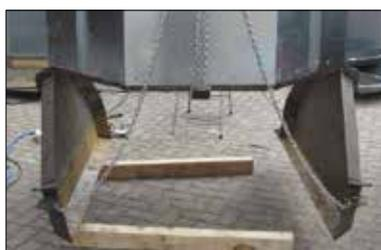
**Na parte interior do contentor, não existem quaisquer partes móveis do sistema de descarga (em sistema de elevação de argola tripla).**
