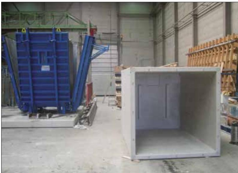
*É sempre usada uma cuba de 5000 litros (4000 litros, por encomenda). O suporte do contentor é integrado no solo e qualquer possível água que possa surgir é drenada através de uma abertura profunda.*
