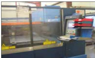
**O CAD corta o desenho no aço, sem necessidade de moldes e custos de instalação.**
